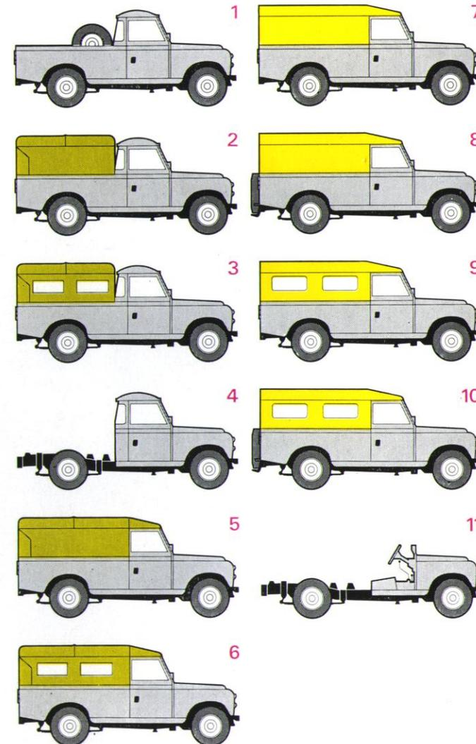
Il modello base della Land-Rover a passo lungo è provvisto di cabina tipo autocarro e di cassone aperto. Tutte le altre versioni (vedi sotto) sono « optional ».
