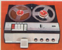
EL 3553 Modèle familial 5.750 F 4 pistes - 2 vitesses: 4,75 et 9,5 cm/sec. jusqu'à 16 h. d'audition. Public address - mélange - mise en parallèle. Duoplay - Multiplay - reproduction stéréo avec préampli EL 3787 (en supplément)
