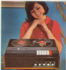
EL 3556 Haute fidélité 8.950 F 4 pistes de 8 heures chacune - 4 vitesses: 2,5 - 4,75 - 9,5 - 19 cm/sec - Mélange - mise en parallèle - public address. Duoplay - Multiplay et reproduction stéréo avec préampli EL 3787 (en supplément) - Coffret en teck.
